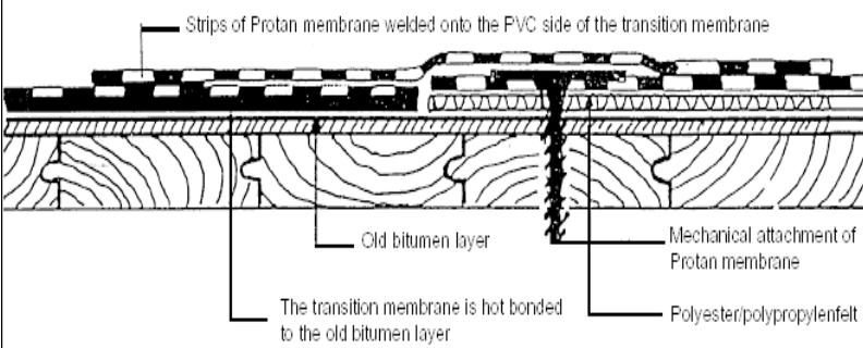
Битумосовместимая мембрана используется для временной связи ПВХ-мембранны "Протан" с битумными материалами. Битумосовместимая мембрана содержит битумный слой с нижней стороны, она приваривается к старому слою битума, а поверх нее приваривается ПВХ-мембрана.
