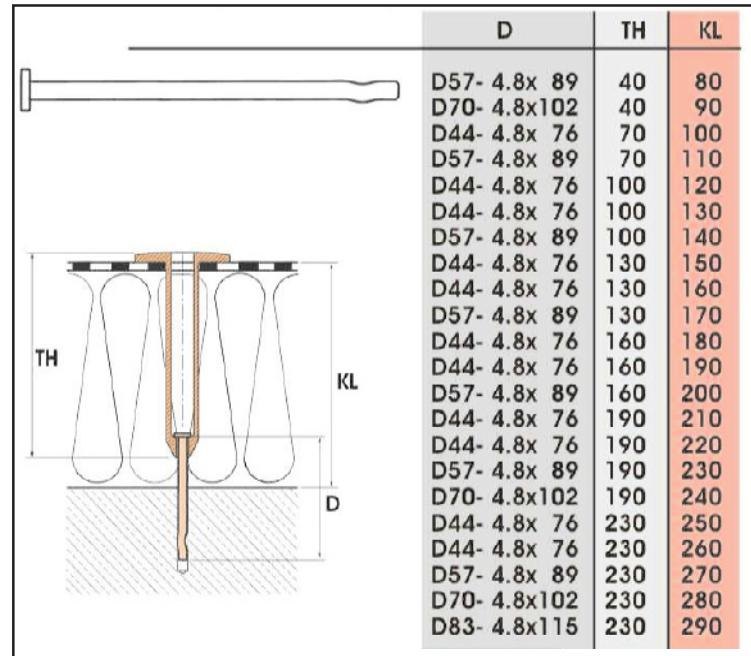
**10.4 Крепления должны устанавливаться в бетон, а не в стяжку. При наличии теплоизоляции , используют телескопические крепления. Необходимо провести испытание креплений "на вырыв".**
