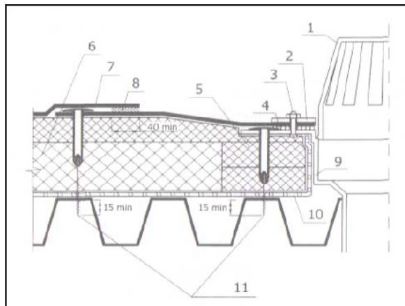
У воронок кровлю выполняют в следующей последовательности:
