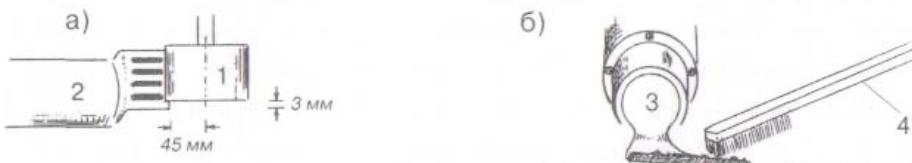
**11.8** В начале рабочего дня, через каждые 200 погонных метров сваренного шва, после каждой перенастройки параметров сварки или после продолжительного перерыва в процессе работы, необходимо проверить качество сварки шва, в случае неудовлетворительного результата заново подобрать режим сварки автоматического оборудования.
