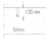
Длина крепежного элемента зависит от основания под кровлю (несущего элемента).
