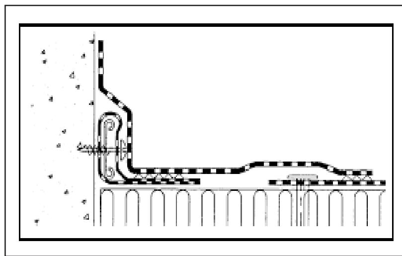
Узел с использованием "ПРОТАН"-кармана самое надежное решение "ПРОТАН" по примыканию мембранны к парапету и стенам.
